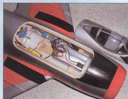
Kompletní osazení modelu: přijímač, servo křídělek, regulátor a zdroj
