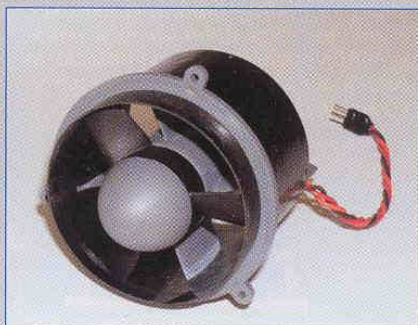
Kompletní dmyhadlo s motorem a vývody k regulátoru
